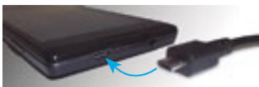
Durante o processo de carga da bateria, o indicador de carga no canto superior direito da tela irá piscar para indicar o carregamento. Mesmo que o telefone esteja desligado, caso algum botão seja pressionado, uma imagem da bateria será mostrada, indicando o recarregamento. Se a carga da bateria estiver muito baixa, esta imagem será mostrada após alguns minutos de recarga.
